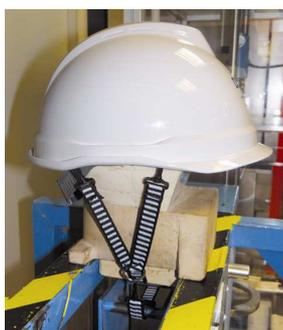
Die Prüfung hinsichtlich **des Brennverhaltens** sieht vor, die Helmschale 10 Sekunden an den Brenner zu halten. 5 Sekunden nach Entfernung des Brenners darf keine Flamme nachbrennen.
