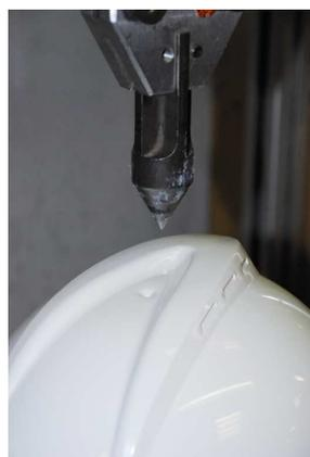
Bei der Prüfung hinsichtlich **Durchdringungsfestigkeit** wird ein 3 kg scharfkantiges Objekt (30°) in Höhe von 1m fallen gelassen (entspricht 29.5 J). Die Spitze darf den Prüfkopf nicht berühren.
